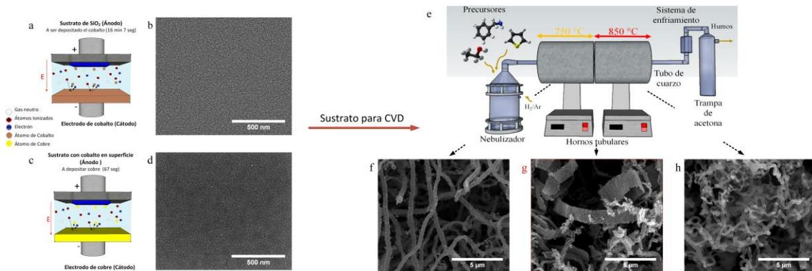
**Figura 1:** Esquema representativo de la deposición física de vapor (a-d) para la formación de sustratos de película delgada de cobalto-cobre y del sistema de deposición química de vapor (e-h) donde, al emplear distintos precursores como bencilamina, etanol y tiofeno pueden obtenerse una variedad de nanoestructuras.
